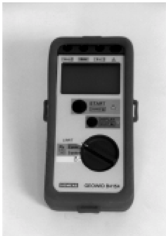
Slika 2. Fotografija mjerila otpora uzemljenja tipa B4154
